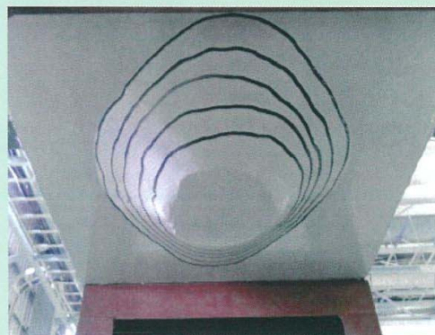
アロンブルコート®Z-X工法の押し抜き試験結果
