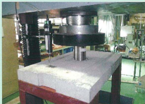
アロンブルコート®Z-X工法の押し抜き試験状況
