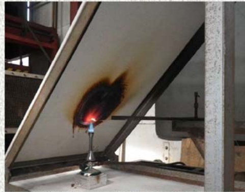
延焼性試験状況
