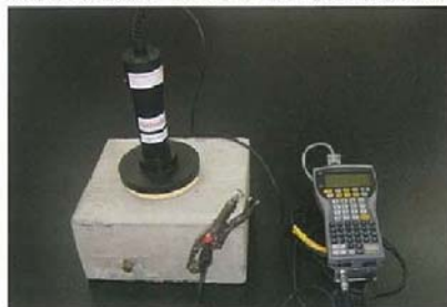
腐食速度測定 Galva Pulse (分極抵抗法)
