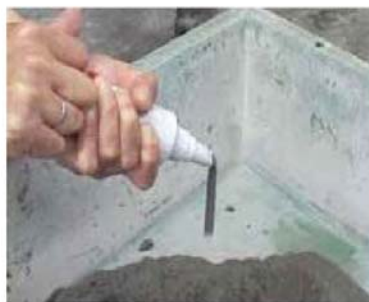
●チクソトロピー性簡易評価試験
